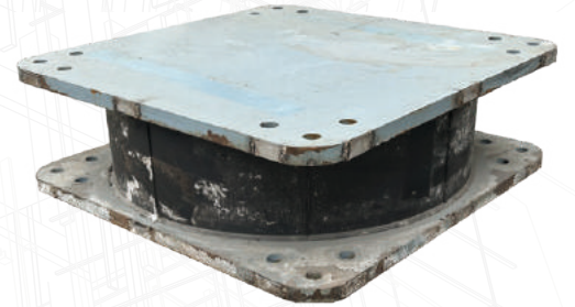
Yangın Koruma Kılıfı sayesinde Yangın Sonrası dayanıklılık testinden başarı ile geçen izolatör
